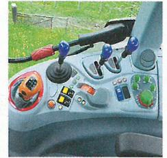
Die einzelnen Bedienelemente sind nach einem farblich abgestimmten Konzept griffgünstig angeordnet.
