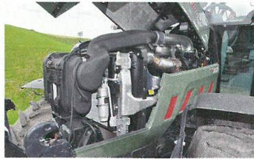
Der Hürlimann «XM 110 T4i» wird von einem elektronisch geregelten 4-Zylinder-Deutz-Motor angetrieben.
