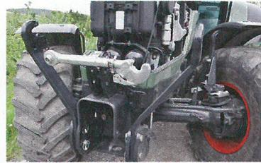
Auf Wunsch gibt es eine gefederte Vorderachse und ab Werk auch Fronthydraulik mit -zapfwelle.
