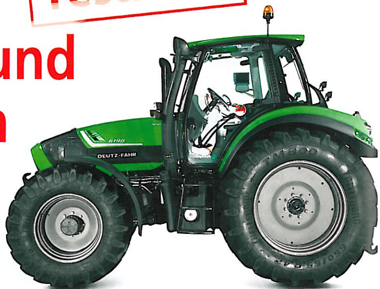
Der neue Sechser erlaubt 5000 kg Zuladung beim Spitzenmodell 6190.
