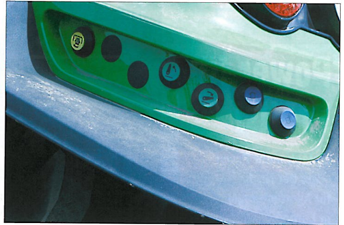
Externe Bedienung am Kotflügel für Heck-Dreipunkt, Zapfwelle und bis zu zwei Steuerventile.
