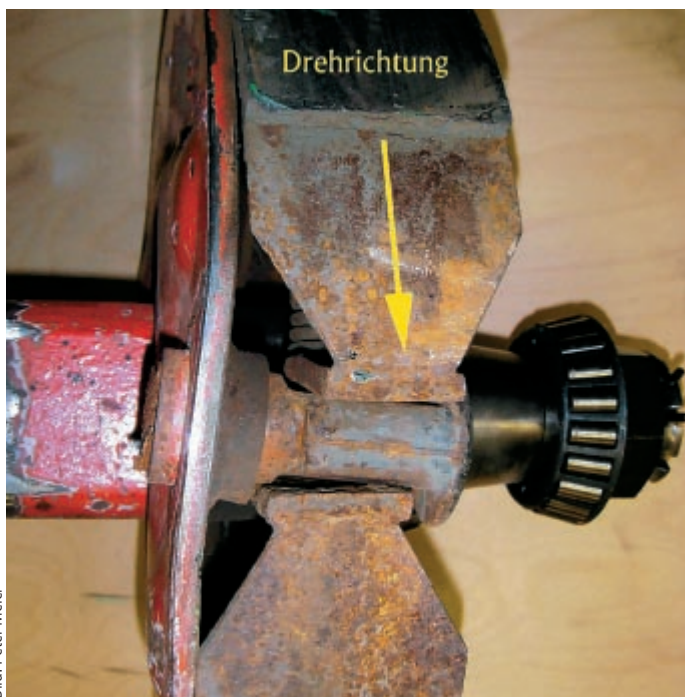
Die Bremswelle der gleichen Bremsanlage, die den Bremsnocken verdreht, ist gebrochen. Der Druck auf der Welle war zu hoch.
