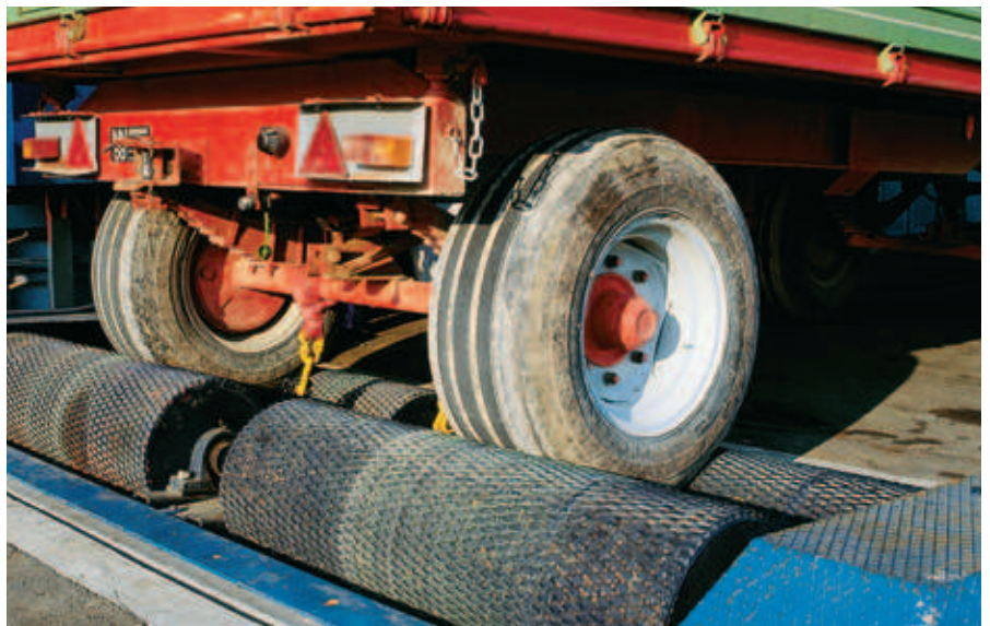
Hydraulische Anhängerbremsen müssen exakt eingestellt sein, damit sie auf das Zugfahrzeug passen. Ein Rollenprüfstand bietet die beste Prüfmöglichkeit.
