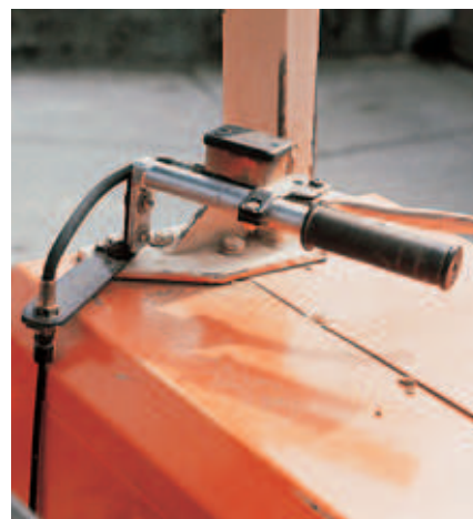
Diese günstige Anhängerbremse lässt sich einfach über den «Töffgriff» bedienen. Sie ist geeignet zur Nachrüstung von vor dem 01.10.1992 in Verkehr gesetzten Traktoren. Für Hangbetriebe ist es von Vorteil, wenn sich die Anhängerbremse separat auch von Hand betätigen lässt.
