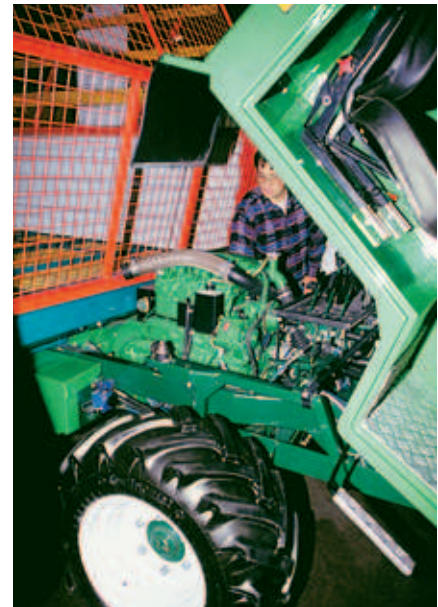
Die Verdrehbarkeit von Vorder- gegen Hinterachse ist zu begrenzen. Eine zweckmässige Lösung ist auch die Rahmenbauweise. Eine kippbare Kabine erleichtert Wartung und Unterhalt.
