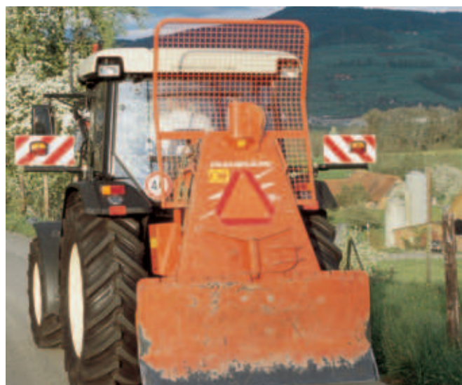
Zusätzliche Beleuchtungs- vorrichtungen am Zugfahrzeug anstelle der Markierlichter können bei kurzen Anbaugeräten die verdeckten Beleuchtungs- vorrichtungen ersetzen.
