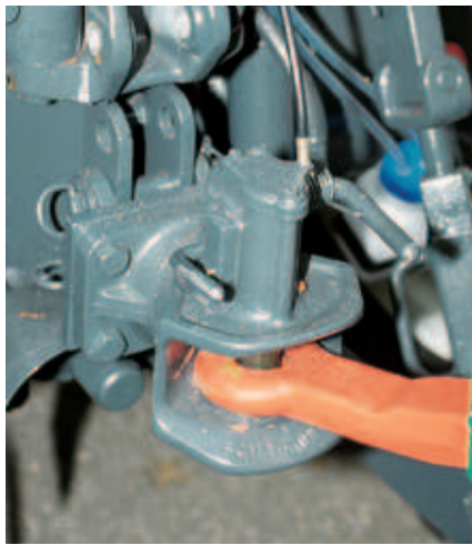
Der Stecknagel mit Sicherung muss sich leicht vom Traktorsitz aus bedienen lassen oder automatisch funktionieren.
