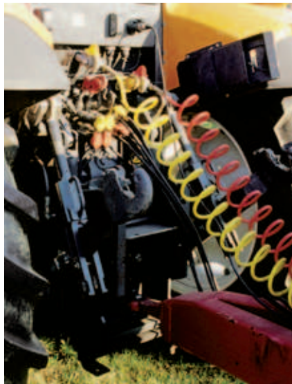
Hydraulische Anhängerbremsen müssen exakt eingestellt sein, damit sie auf das Zugfahrzeug passen. Ein Rollenprüfstand bietet die beste Prüfmöglichkeit.
