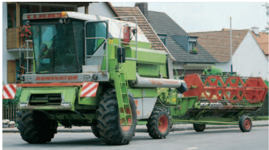
Mehr als 3,5 m breite Schneidwerke müssen längs transportiert werden.
