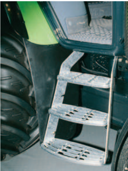
Korrektcr Aufstieg: Leicht begehbar, rutschhemmend, ideale Stababstände und seitliche Anschläge.
