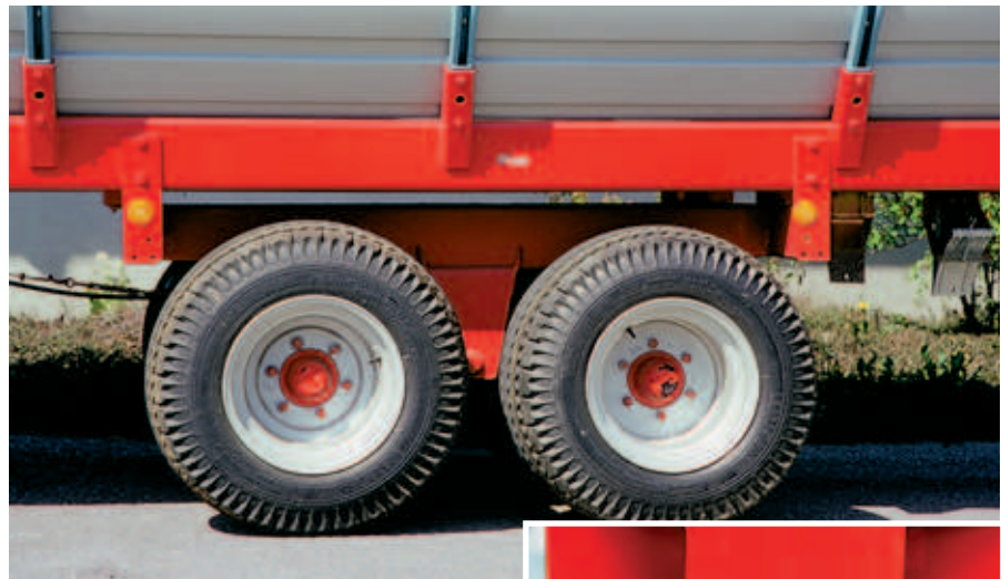
Ist ein Anhänger länger als 5 m, sind seitlich, links und rechts, rote oder orange Rückstrahler erforderlich.
