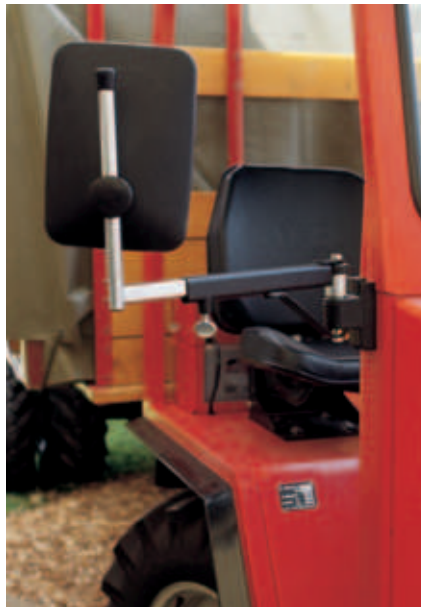
Gute Lösung einer ausziehbaren Halterung für Transporterspiegel.
