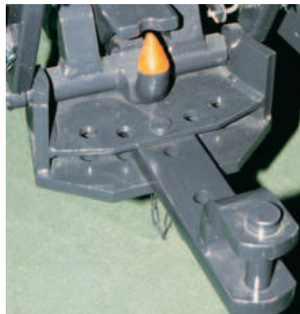
Hitch (orange Spitze) und Zugpendel, Stützlasten siehe Betriebsanleitung.
