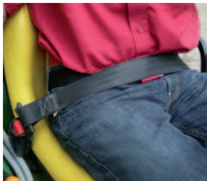
Bei Traktor- und Transporterstürzen wird der Fahrer oft aus dem Schutzbereich geschleudert. Deshalb sollten vermehrt Sicherheitsgurte eingebaut werden. Wo vorhanden, sind sie auch zu tragen.
