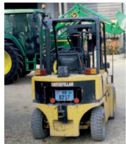
Gabelstapler benötigen auf öffentlichen Verkehrsflächen ein Kontrollschild oder eine spezielle Bewilligung. Ein Rückhaltesystem ist erforderlich.
