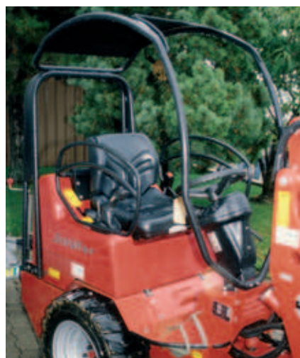
Hoflader müssen mit einer Schutzvorrichtung und Fahrerrückhaltesystem ausgerüstet sein, wenn Grossballen oder ähnliches transportiert werden.
