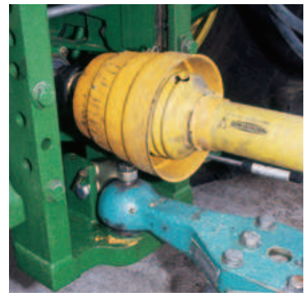
Untenanhängung mit Kugelkupplung. Dieses System hat sich auch für schwerste Lasten bewährt. Der Fahrkomfort und die Verdrehmöglichkeiten sind besser. Besonders zu beachten ist der korrekte Schutz der exponierten Gelenkwelle!
