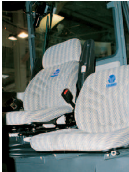
Traktorsitze müssen gute Verstellmöglichkeiten und ergonomische Rückenstützen aufweisen. Solche, die Mängel aufweisen, sind dem Rücken zuliebe zu ersetzen oder zu reparieren. Eine regelmässige Wartung ist erforderlich.
