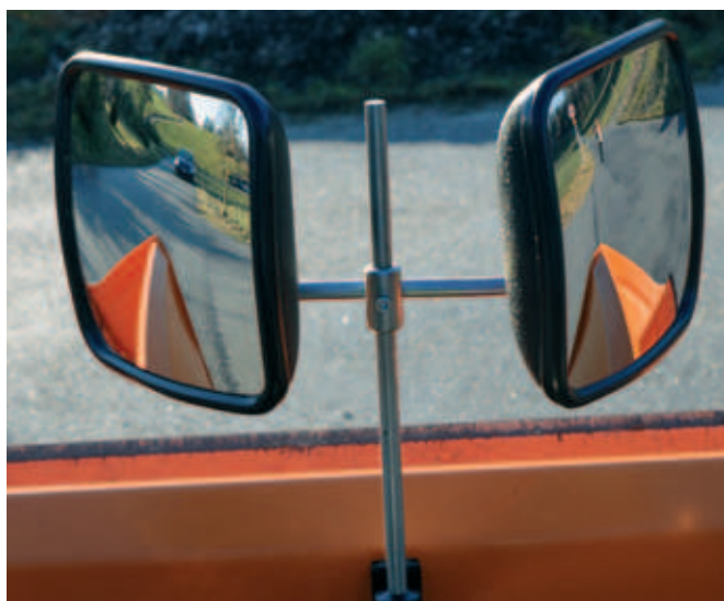
Um die Ausfahrt an unübersichtlichen Stellen zu erleichtern, sind Frontanbaugeräte mit mehr als 3 m Überhang mit Seitenblickspiegeln auszurüsten.
