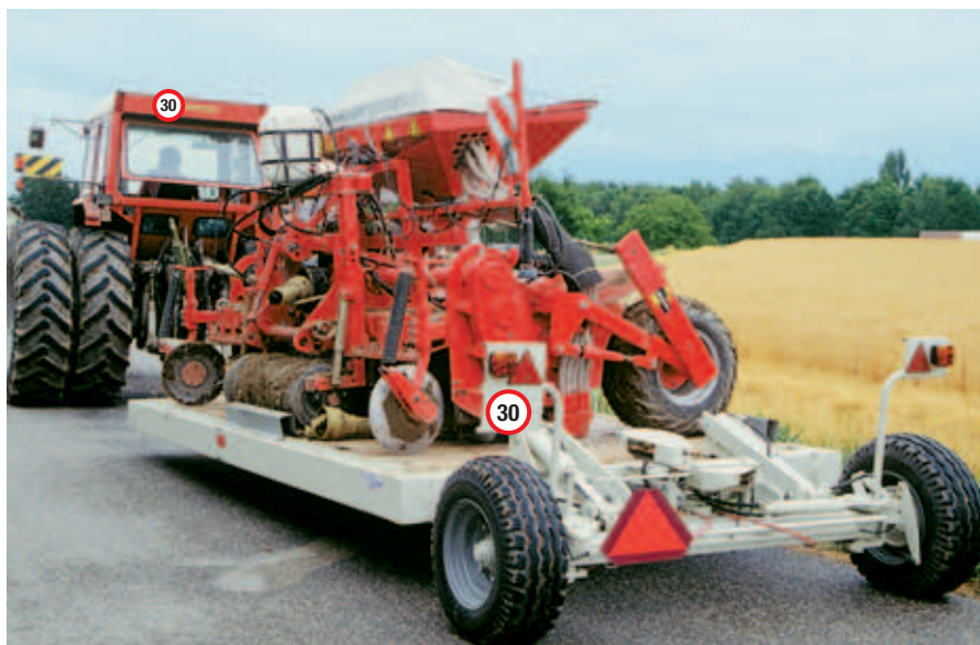
Praktischer hydraulisch absenkbarer Transportwagen für Anbaugeräte. Sind diese breiter als 3,5 m, müssen sie längs transportiert werden.
