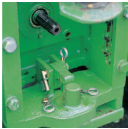
Untenanhängung mit Piton-fix. Die Untenanhängung erlaubt die Ausnutzung der maximalen Stützlast von 3 t. Die Fahrsicherheit wird wesentlich erhöht, insbesondere mit höheren Geschwindigkeiten. Eine gefederte Deichsel ist von Vorteil.
