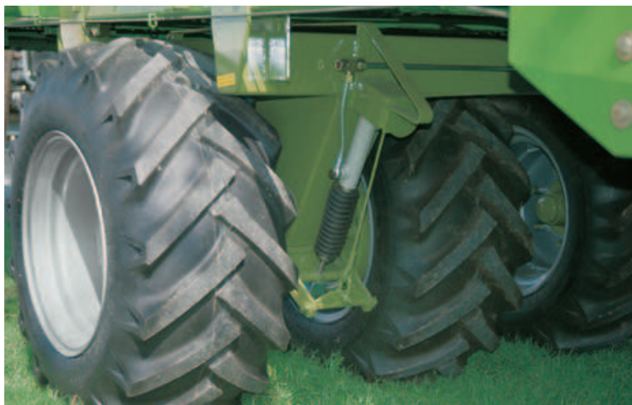
Hydraulische Anhängerbremsen müssen fachmännisch eingebaut werden. Bei solchen Achsen müssen sie auf alle Räder wirken.
