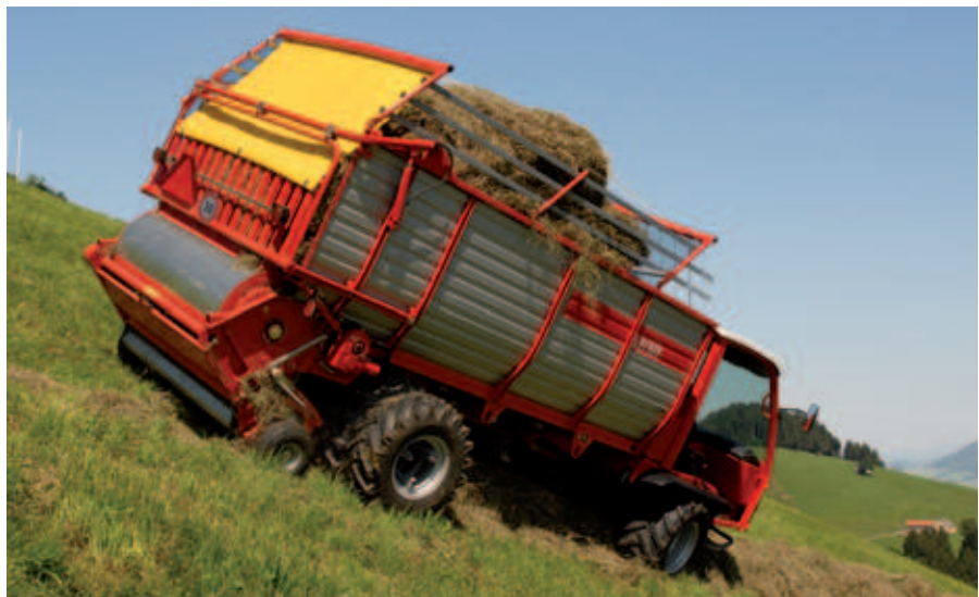
Transporter mit Aufbauten haben eine ideale Gewichtsverteilung für Fahrten auf der Strasse und im Gelände. Werden sie ohne Aufbauten als Zugfahrzeuge verwendet, sind sie stark kopflastig und deshalb mit zusätzlichen Heckgewichten auszurüsten. Neu brauchen Transporter auch eine Heckmarkierung.
