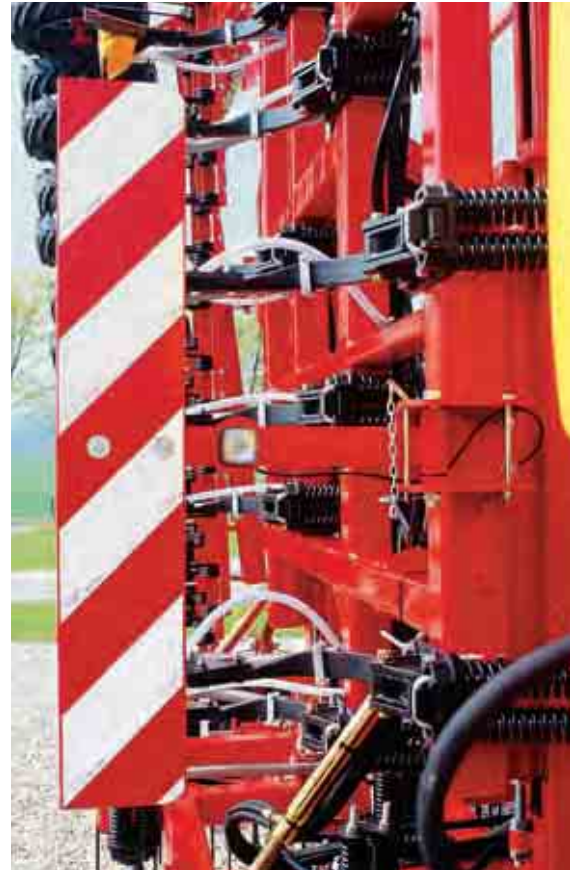
Abdeckung von Federzinken mit einem Winkelblech. Die angebrachte Markierungsfolie erhöht die Sichtbarkeit wesentlich.
