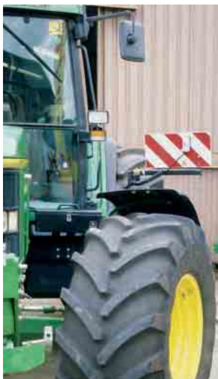
Landwirtschaftliche Motorfahrzeuge dürfen bis zu einer Breite von 3 m mit vorübergehend erforderlichen Doppelrädern ausgerüstet werden. Die Fahrzeugbreite muss tags mit Markierungstafeln, nachts und bei schlechter Witterung mit Markierlichtern gekennzeichnet werden. Es wird empfohlen, die Markierungstafeln und Markierlichter am Traktor fest, beziehungsweise auszieh- und/oder klappbar anzubringen.
