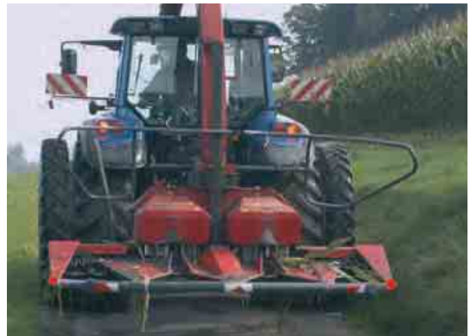
4 Die Konturen sind nicht leicht erkennbar, Spitzen sind gefährliche Teile. Markierungen und Abdeckung sind erforderlich.
