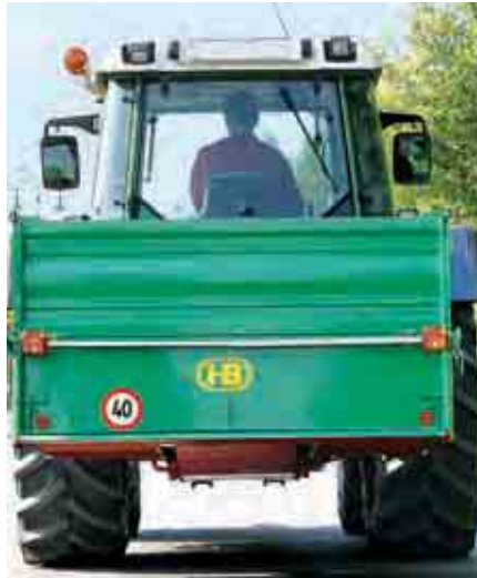
Für Ladeflächen mit Rückwand sind Beleuchtungsanlagen und Rückstrahler, aber weder Markierungstafeln noch Abdeckung erforderlich.
