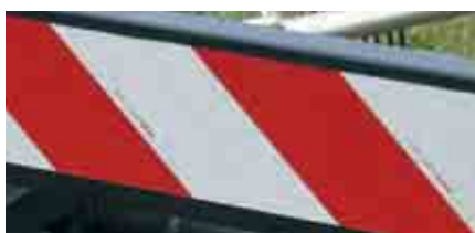
Für die Markierung landwirtschaftlicher Fahrzeuge sind sowohl rot/weiss wie gelb/schwarz gestreifte Markierungstafeln erlaubt. Retroreflektierende Markierungen erhöhen die Sichtbarkeit deutlich.
