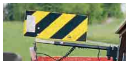
Für die Markierung landwirtschaftlicher Fahrzeuge sind sowohl rot/weiss wie gelb/schwarz gestreifte Markierungstafeln erlaubt. Retroreflektierende Markierungen erhöhen die Sichtbarkeit deutlich.
