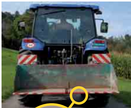
Für Ladeflächen mit Rückwand sind Beleuchtungsanlagen und Rückstrahler, aber weder Markierungstafeln noch Abdeckung erforderlich.
