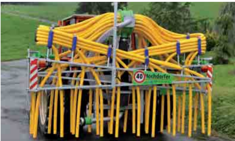
Die Konturen dieses Schleppschauchverteilers sind trotz der gelben Schläuche nicht leicht erkennbar. Die Markierungstafeln dürfen nicht verdeckt sein und müssen nach hinten und vorne wirken. Werden die Beleuchtungsvorrichtungen und/oder Rückstrahler verdeckt, sind gleichwertige Ersatzvorrichtungen anzubringen.
