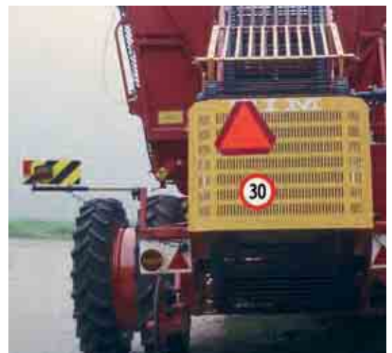
Das Anbringen von Markierungstafeln ist notwendig. Zusätzliche Abdeckungen von gefährlichen Fahrzeugteilen sind bei diesem Anhänger nicht notwendig. Vorne und hinten sind Rückstrahler erforderlich. Lichter und Richtungsblinker sollten fest montiert sein.
