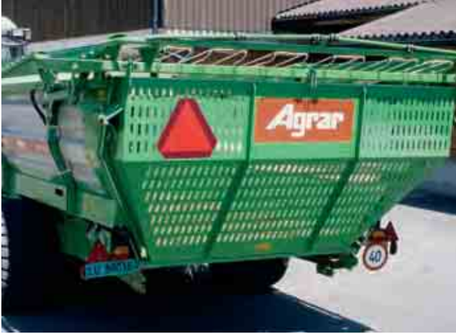
1 Die Konturen sind leicht erkennbar. Markierungstafeln oder Abdeckungen sind nicht erforderlich.
