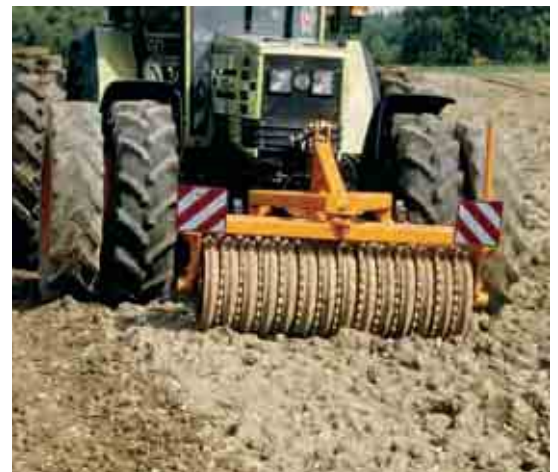
Beim Anhänger sind vorne und hinten Markierungstafeln sowie Rückstrahler erforderlich. Auch Lichter und Richtungsblinker sollten fest montiert sein. Bei der Frontwalze sind Rückstrahler und Markierungstafeln erforderlich.
