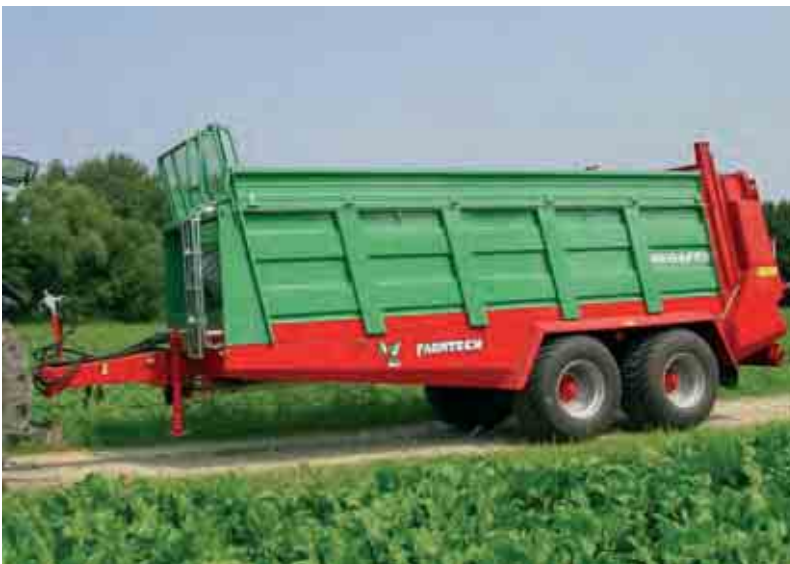
Es ist in jedem Fall eine Abdeckung des Streuaggregates erforderlich. Erfahrungsgemäss sind nur hydraulisch bedienbare Abdeckungen praxistauglich. Diese sollten durch ihre Konstruktion verhindern, dass Streugut auf die Strasse fällt. Die Beleuchtungsvorrichtungen und Rückstrahler sollten so angebracht sein, dass sie möglichst wenig verschmutzen.
