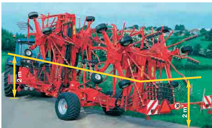
Gefährliche Teile in der Randzone sind bis auf eine Höhe von 2 m abzudecken oder zu entfernen. Gefahren innerhalb der markierten/geschützten Konturen müssen nicht zusätzlich abgedeckt werden.
