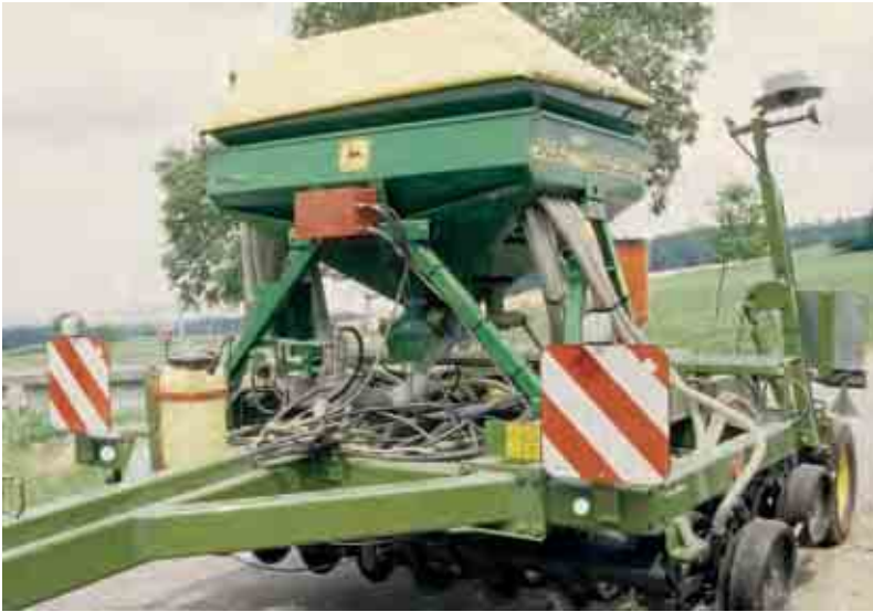
Das Anbringen von Markierungstafeln ist notwendig. In diesem Beispiel sind keine Abdeckungen von gefährlichen Fahrzeugteilen erforderlich. Vorne und hinten sind Rückstrahler erforderlich. Auch Lichter und Richtungsblinker sollten fest montiert sein.
