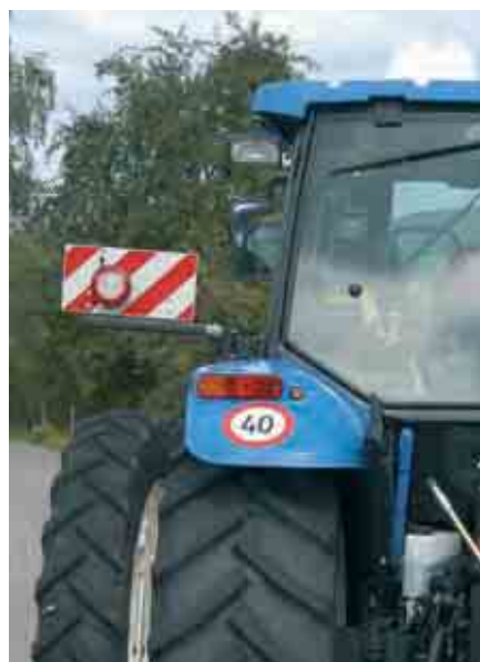
Landwirtschaftliche Motorfahrzeuge dürfen bis zu einer Breite von 3 m mit vorübergehend erforderlichen Doppelrädern ausgerüstet werden. Die Fahrzeugbreite muss tags mit Markierungstafeln, nachts und bei schlechter Witterung mit Markierlichtern gekennzeichnet werden. Es wird empfohlen, die Markierungstafeln und Markierlichter am Traktor fest, beziehungsweise auszieh- und/oder klappbar anzubringen.
