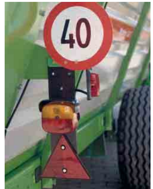
Es ist in jedem Fall eine Abdeckung des Streuaggregates erforderlich. Erfahrungsgemäss sind nur hydraulisch bedienbare Abdeckungen praxistauglich. Diese sollten durch ihre Konstruktion verhindern, dass Streugut auf die Strasse fällt. Die Beleuchtungsvorrichtungen und Rückstrahler sollten so angebracht sein, dass sie möglichst wenig verschmutzen.
