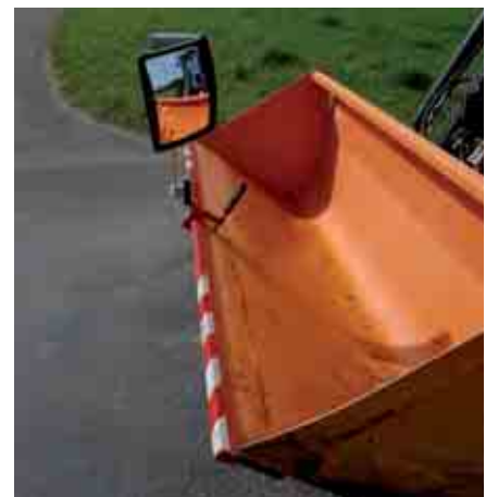
Kombischaufeln weisen Kanten von über 2,5 mm Radius oder 5 mm Ø auf (Bild links). Abgeschliffene Flächen können Schneiden aufweisen. Diese müssen abgedeckt werden.
