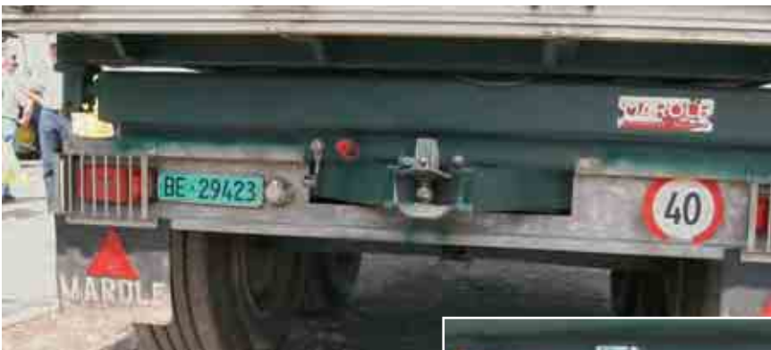
Landwirtschaftliche Anhänger sind richtig zu beleuchten. Seit dem 1.1.09 müssen alle Anhänger ein Höchstgeschwindigkeitszeichen aufweisen. Zugvorrichtungen müssen genügend stark sein. Allfällige, vom Hersteller vorgegebene Anhängelasten sind einzuhalten.
