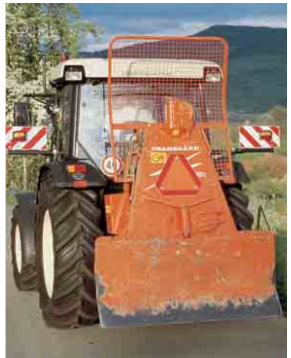
Mit Seilwinden sind Landwirte oft in der Dämmerung unterwegs. Eine gute Beleuchtung ist unerlässlich. Hier hilft die zusätzliche Beleuchtungseinrichtung des Traktors, die auch für die Doppelbereifung verwendbar ist.
