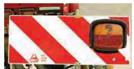
Markierungstafel mit Beleuchtungsvorrichtungen
