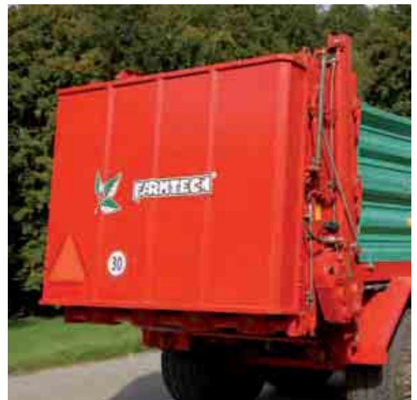
Es ist in jedem Fall eine Abdeckung des Streuaggregates erforderlich. Erfahrungsgemäss sind nur hydraulisch bedienbare Abdeckungen praxistauglich. Diese sollten durch ihre Konstruktion verhindern, dass Streugut auf die Strasse fällt. Die Beleuchtungsvorrichtungen und Rückstrahler sollten so angebracht sein, dass sie möglichst wenig verschmutzen.
