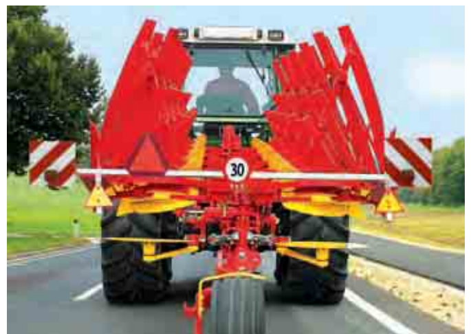
4 Die Konturen sind nicht leicht erkennbar, Spitzen sind gefährliche Teile. Markierungen und Abdeckung sind erforderlich.
