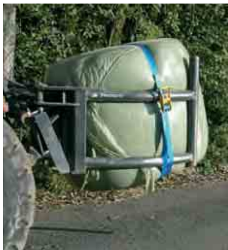
Mit geeigneten Transportgeräten darf am Heck eine gesicherte Grossballe transportiert werden.
