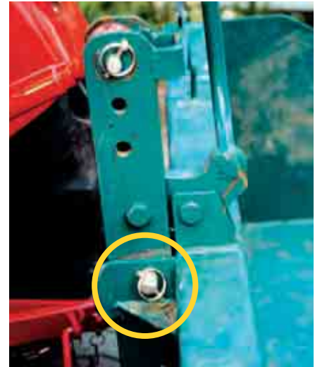
Eine Kombischaufel gilt dann als Ladefläche, wenn der Kippmechanismus mechanisch verriegelt und gesichert ist.
