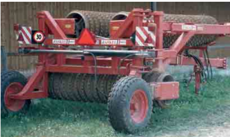
Beim Anhänger sind vorne und hinten Markierungstafeln sowie Rückstrahler erforderlich. Auch Lichter und Richtungsblinker sollten fest montiert sein. Bei der Frontwalze sind Rückstrahler und Markierungstafeln erforderlich.
