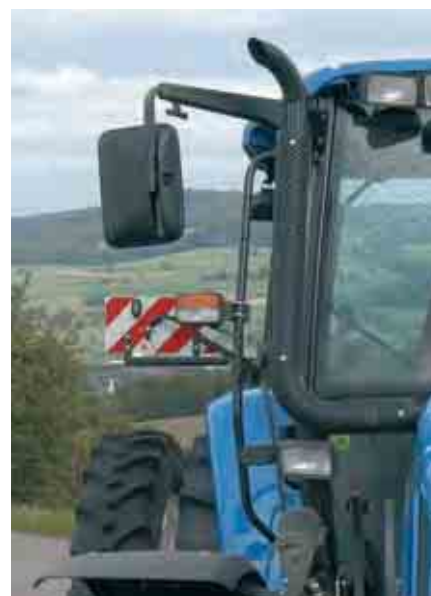
Landwirtschaftliche Motorfahrzeuge dürfen bis zu einer Breite von 3 m mit vorübergehend erforderlichen Doppelrädern ausgerüstet werden. Die Fahrzeugbreite muss tags mit Markierungstafeln, nachts und bei schlechter Witterung mit Markierlichtern gekennzeichnet werden. Es wird empfohlen, die Markierungstafeln und Markierlichter am Traktor fest, beziehungsweise auszieh- und/oder klappbar anzubringen.
