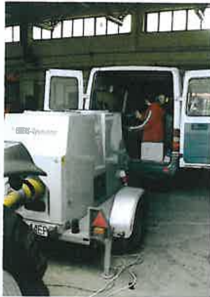
Mit einer Zapfwellenbremse wurde bei allen Testkandidaten die Leistung und der Dieserverbrauch gemessen.
